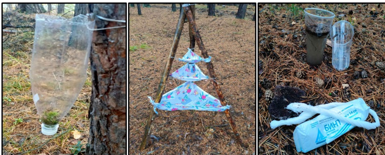
а.) фильтр из пластиковой бутылки, б.) фильтр «тренога», в.) фильтр из тканевого жгута
