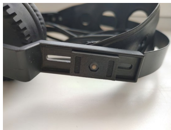
Рисунок 2 – Напечатанное крепление для ободка наушников
