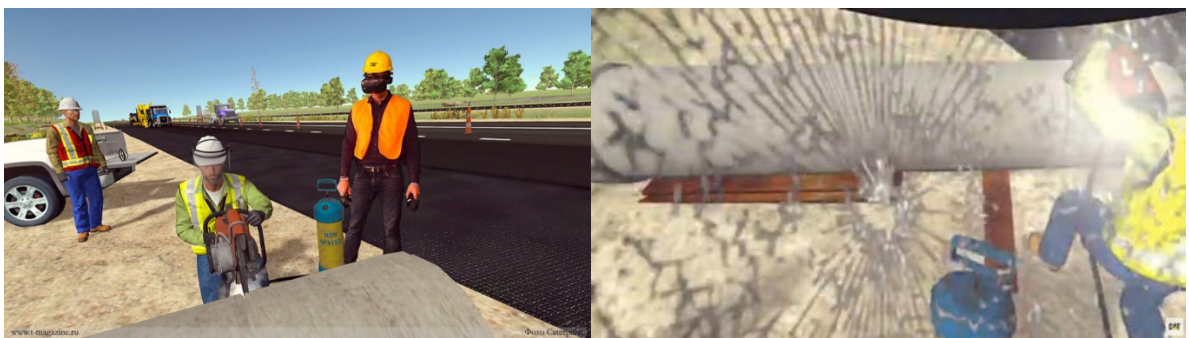
Рис 10. Модуль Caterpillar Safety VR показывает, что происходит при нарушении ТБ в дорожном строительстве: рабочий справа пилит трубу болгаркой, осколок отлетает в голову ученика. Последствия показаны так, будто разбилось стекло очков виртуальной реальности.
