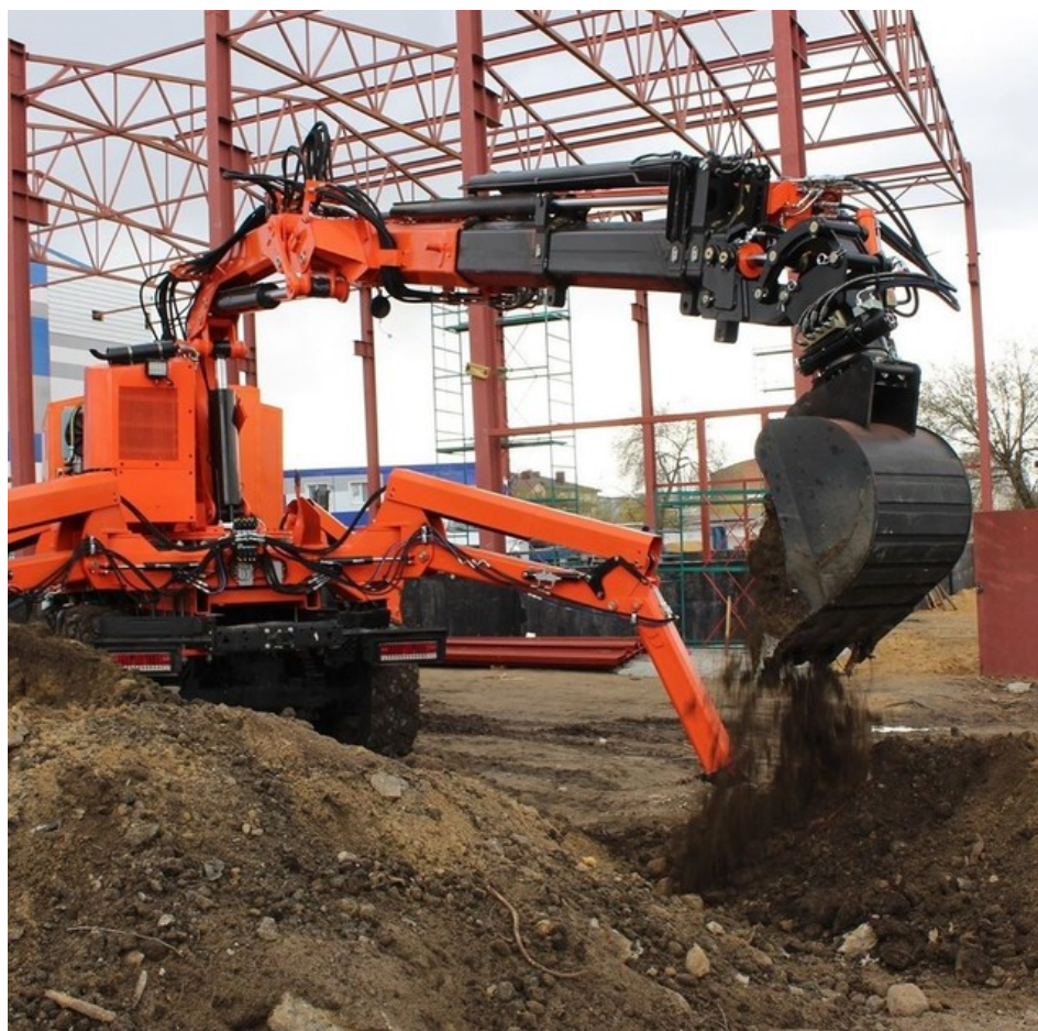
Рис 6. Это РОИН Р-700 — российский робот, который спроектирован для простых работ в опасных для человека условиях. Робот умеет копать, бурить, дробить, перемалывать кусты.
